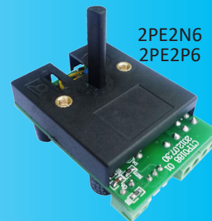
Глухой электронный термостат, температурный диапазон до 200°C. Датчик NTC или Pt100
